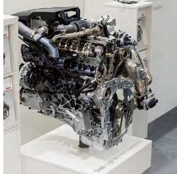
3,0-l-Duramax-Diesel-Sechszylinderreihenmotor von General Motors (© ÖVK | Klaus Ranger)
